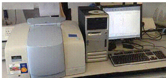
Fig. 7.3. Espectrómetro Perkin-Elmer PRECISELY Spectrum 100 FT-IR.
